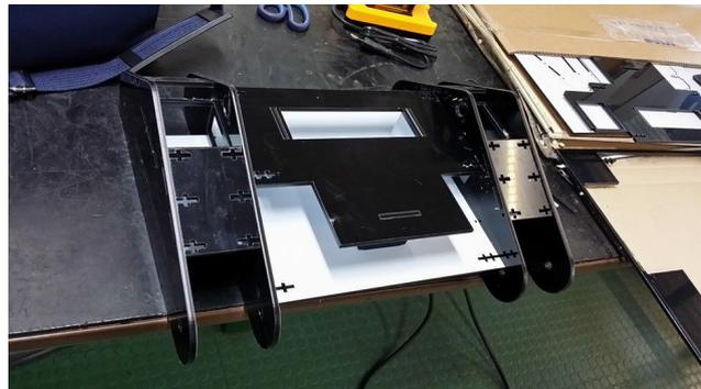
Figura 10: Telaio in materiale acrilico
