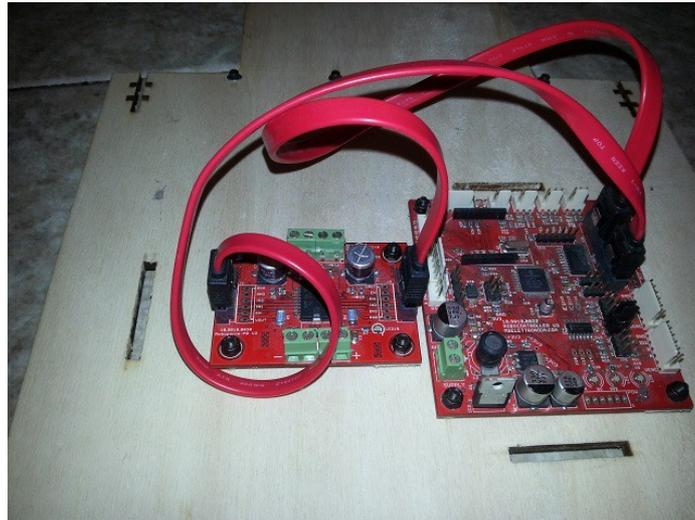
*Figura 12: RoboPonte-MD connesso alla RoboController V2 tramite robusti cavi SATA e assemblato su prototipo in legno del telaio*
