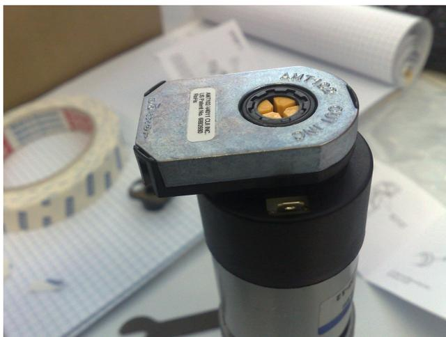
Figura 11: Micromotors e192-12-18 con encoder CUI inc AMT102-V
